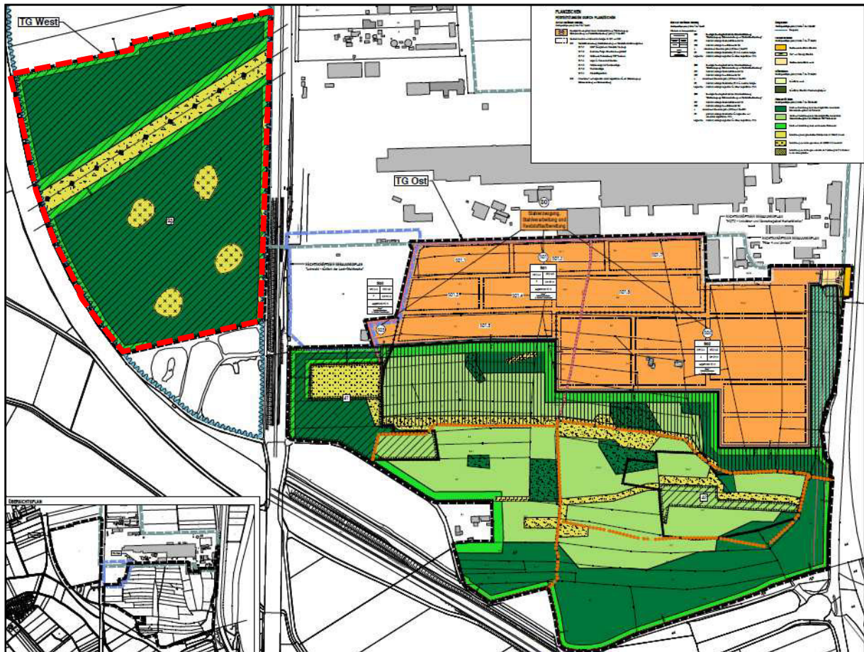
Abb. 2: Entwurf des Bebauungsplan Stand vom 13.11.2019; orange Sondergebiet, dunkel-/hellgrün Laubwald/Waldrand, lindgrün Mittelwald, gelb Ausgleichsflächen/Lichtungen/blütenreiches Grünland.
